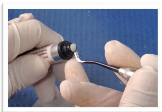
Confección de los especímenes de resinas
