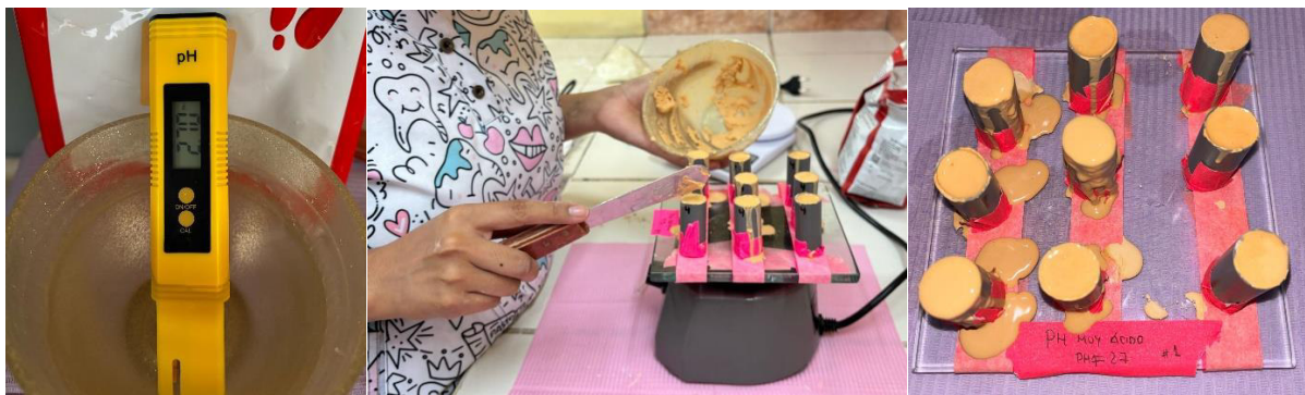
Imagen 5: Confección de 9 muestras de yeso tipo IV marca Zhermack ® con agua de pH muy ácido (pH 2.7)
