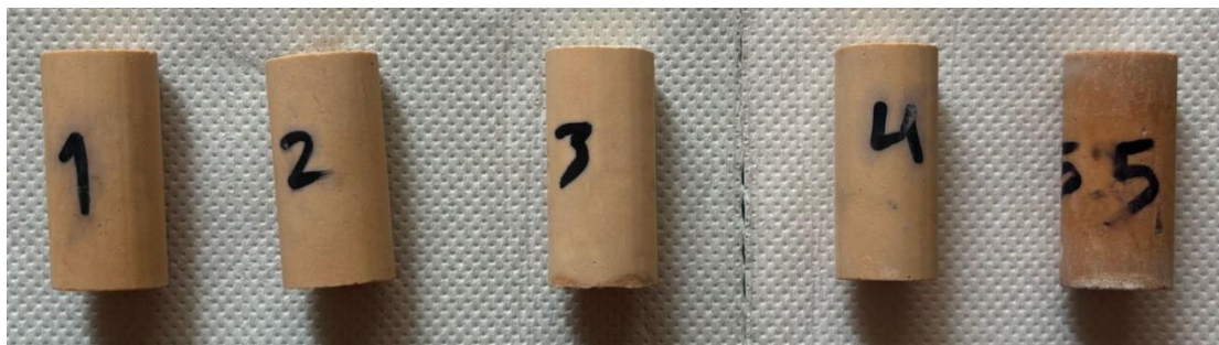
Imagen 8: Muestras cilíndricas fraguadas, desmoldadas y regularizadas
