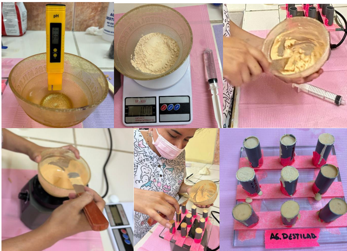
Imagen 3: Confección de 9 muestras de yeso tipo IV marca Zhermack ® con agua de pH neutro (pH 7.01)
