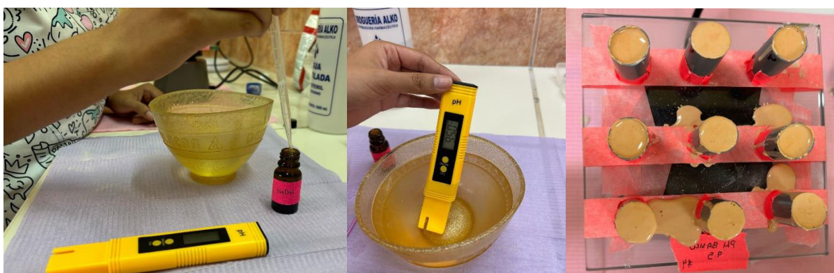
Imagen 6: Confección de 9 muestras de yeso tipo IV marca Zhermack ® con agua de pH alcalino (pH 9.5)
