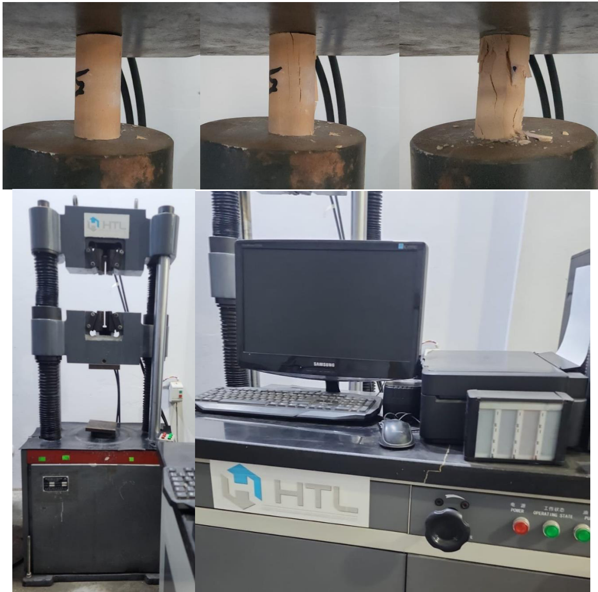
Imagen 11: Muestras sometidas a prueba de resistencia compresiva en la máquina de ensayo universal y registrado en software.
