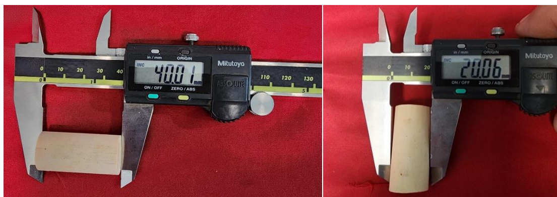
Imagen 10: Corroborando las medidas con la ayuda de un pie de rey digital Mitutoyo-200 mm.
