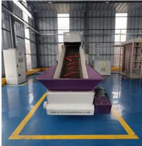
**Etapa 3:** Proceso de trituración y molienda, para la posterior separación del cobre de los plásticos.
