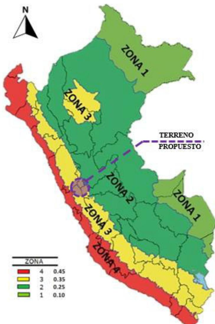
*Nota.* Adaptado de *Zonificación sísmica del Perú* [Captura de Pantalla], por Ministerio de vivienda, saneamiento y construcción - Norma técnica E.030 diseño sismo resistente, 2019,
