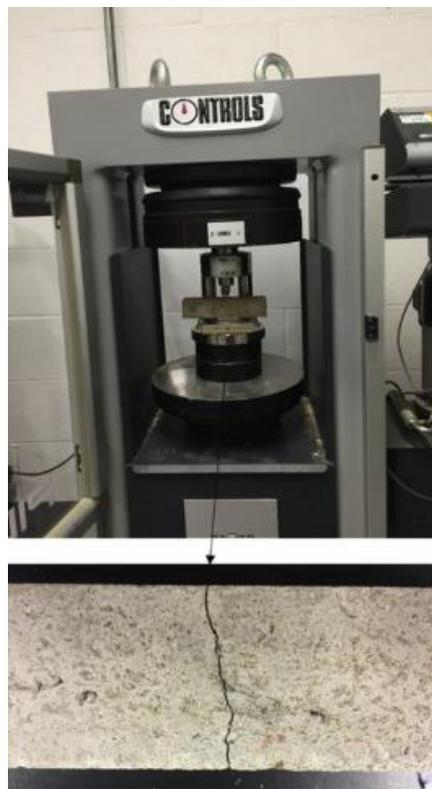
*Nota:* Máquina universal para prueba de flexión de tres puntos con velocidad de deformación controlada utilizada para generar una grieta en el medio de las muestras. (Souid, 2019).
