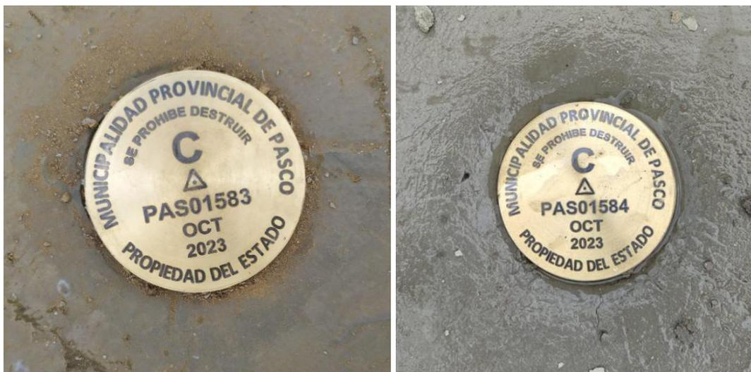
*Nota.* Se observan los puntos geodésicos dispuestos dentro del distrito de Chaupimarca, PAS01583 y PAS01584.
