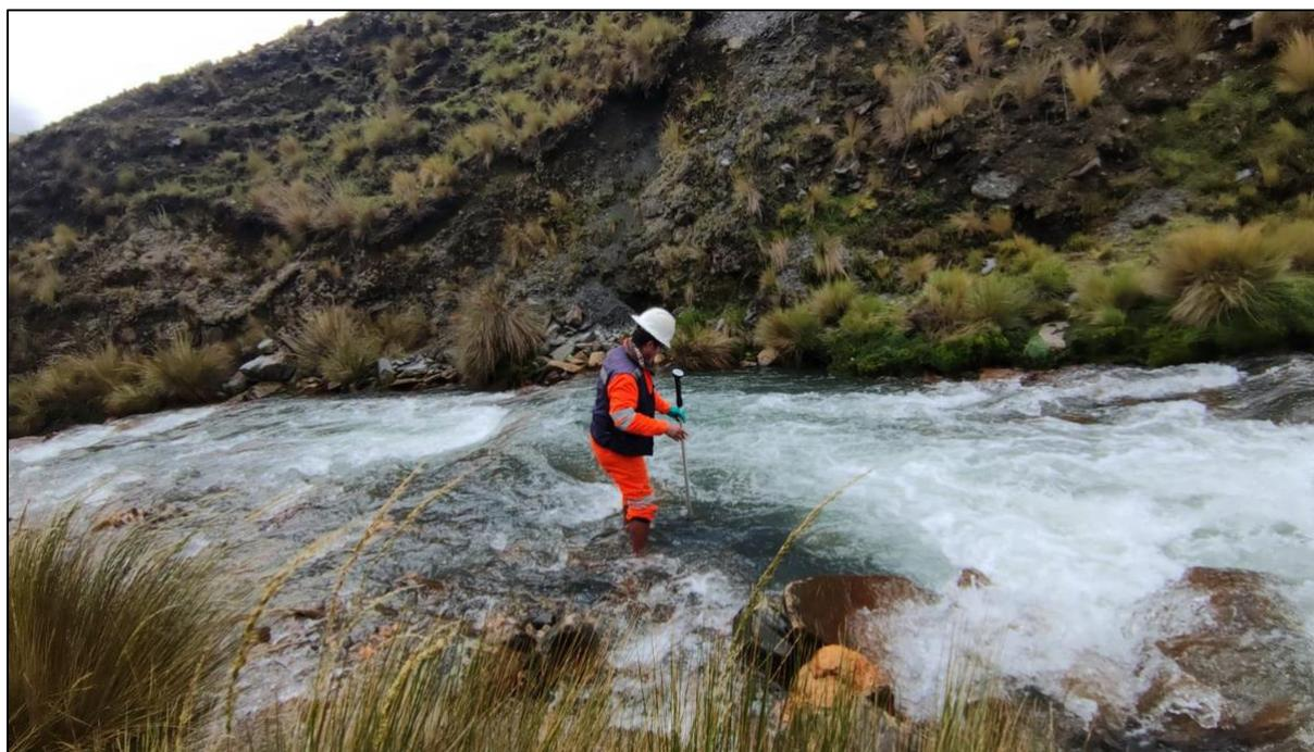
*Nota.* Medición de la velocidad del río con el correntómetro, uno de los principales afluentes del río Choquechambi son las aguas que descarga la quebrada Ananea.
