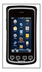
Nota. Controladora de marca Trimble y modelo Juno T41, para uso del equipo receptor GNSS
