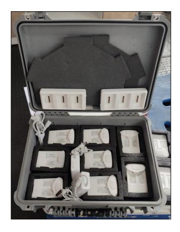
Nota. Baterías para modelo Phantom 4 Pro V2, cargadores, cables y maleta de transporte.
