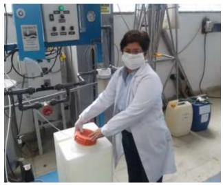
Foto 3 Tanque de Peróxido de Hidrogeno del Sistema de tratamiento POA
