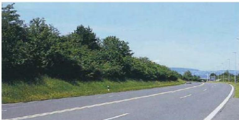
Figura 6. Barrera acústica tipo talud arborizado. Tomado de KOTZEN, Benz. 1999. Environmental Noise Barrier. E & FN Spum. Pagina 65.
