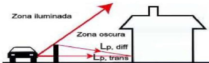
Figura 4. Forma del apantallamiento de la transmisión del estruendo por una barrera estruendosa. Tomado de KOTZEN, Benz. 1999. Environmental Noise Barrier. E & FN Spum. Pagina 36.
