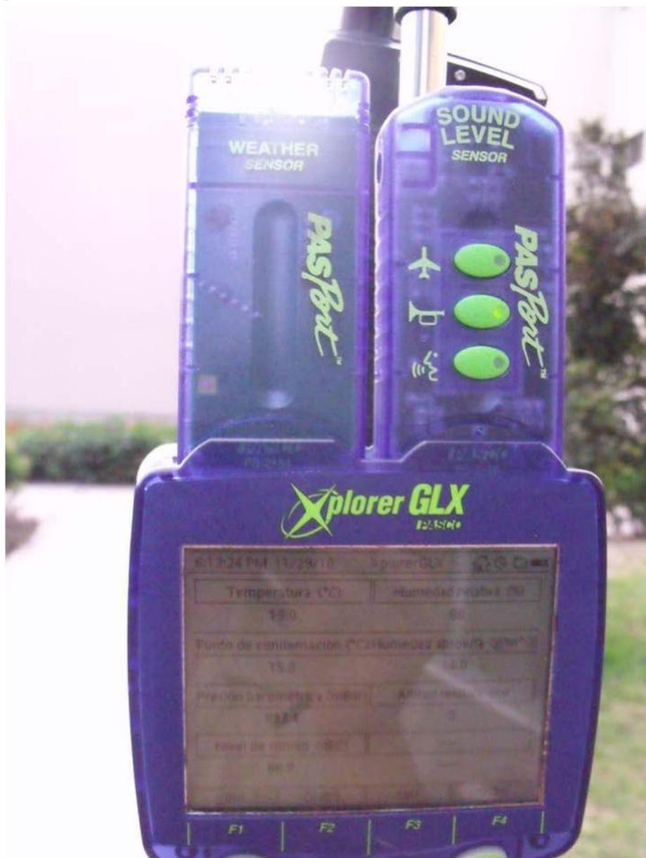
Figura 27. Sensor de condiciones climáticas
