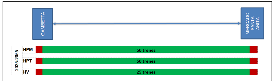
Figura N° 95: Estimación de número de trenes en operación según banda horaria – Estación Gambetta hasta Estación Mercado Santa Anita
