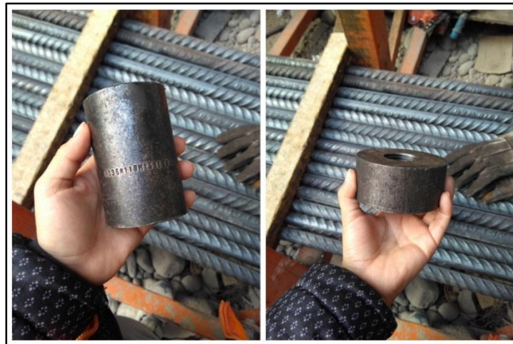
Figura 1. Conector tipo rosca de continuidad (izquierda) y de cabeza o anclaje (derecha). Elaboración propia
