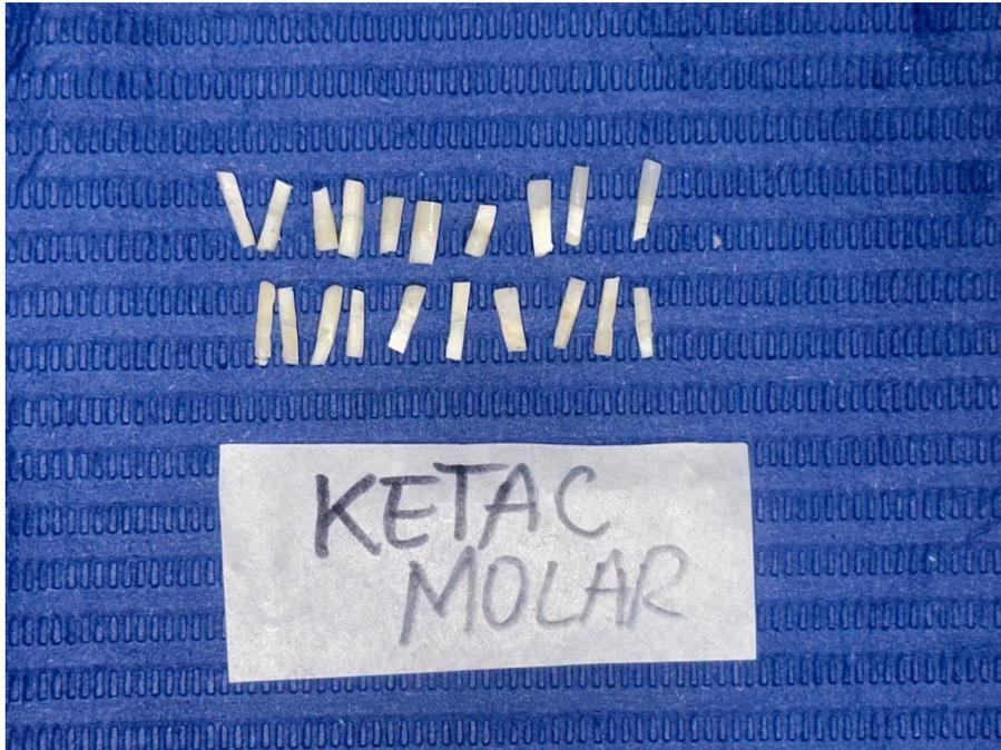
*C15: Muestras respectivas del ionómero GC Fuji IX GP y Ketac Molar Easymix, preparadas para pasar por la máquina universal de ensayos.*
