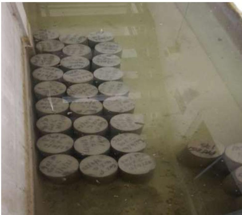
Curado de probetas
