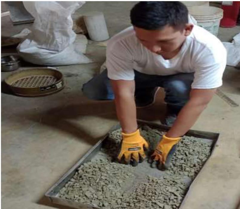
F. Para análisis granulométrico de agregados grueso se utilizó las mallas de  $\frac{3}{4}$ ",  $\frac{1}{2}$ ",  $\frac{3}{8}$ " y  $\frac{1}{4}$ ", siguiendo los procedimientos indicados en la norma ASTM C 33 como se muestra en la figura 11.
