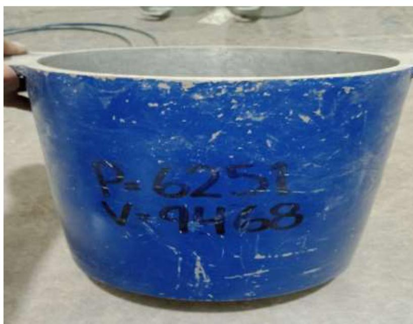
Se procedió a realizar el ensayo de peso unitario siguiendo los procedimientos descritos en ASTM C29. Se calculó el peso de recipiente y material compactado y se dividió entre el volumen del envase calculado previamente como se muestra en la figura 16.
