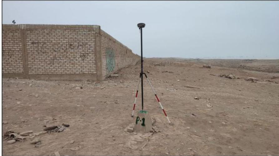
*Nota.* Posicionamiento de punto de control PC-01 en modo RTK.
