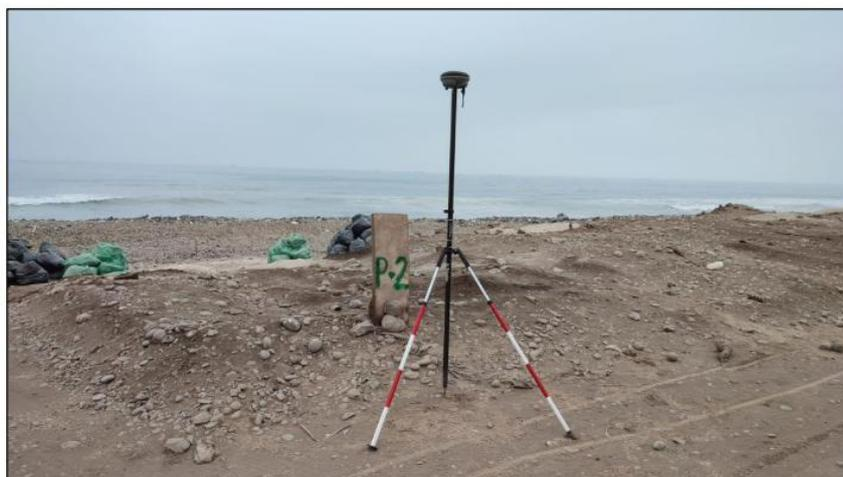
*Nota.* Posicionamiento de punto de control PC-02 en modo RTK.
