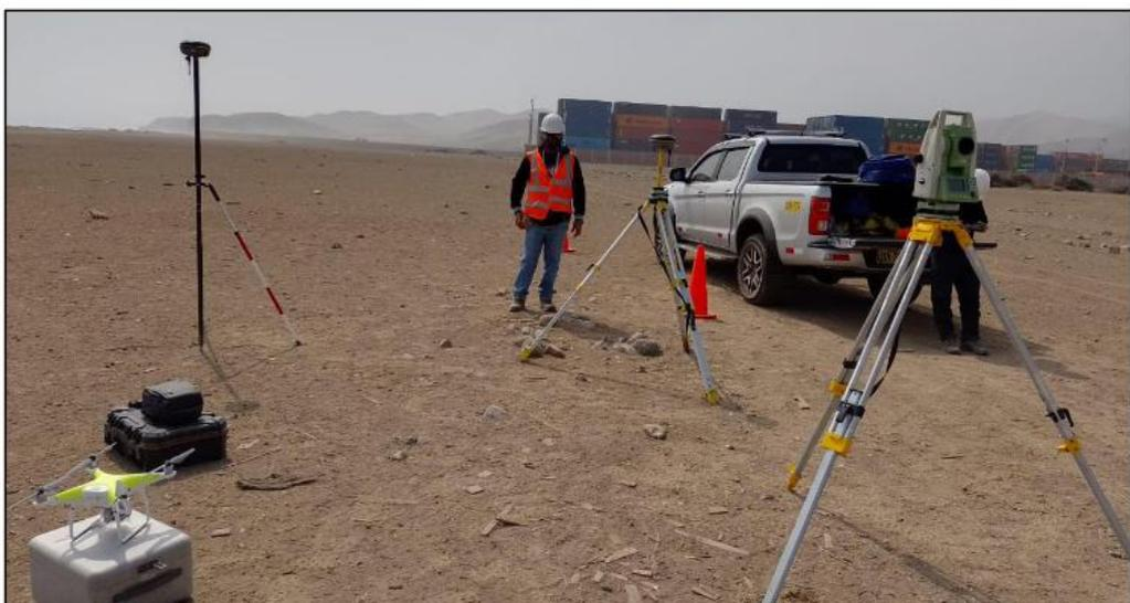
*Nota.* Equipos utilizados para el vuelo fotogramétrico.
