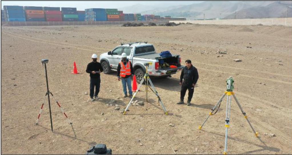
*Nota.* Equipos utilizados para el vuelo fotogramétrico.
