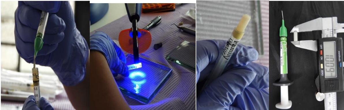
Imagen 4: Confección de 10 muestras de resina de baja densidad sin fibra de vidrio (EverX Flow™ GC).
