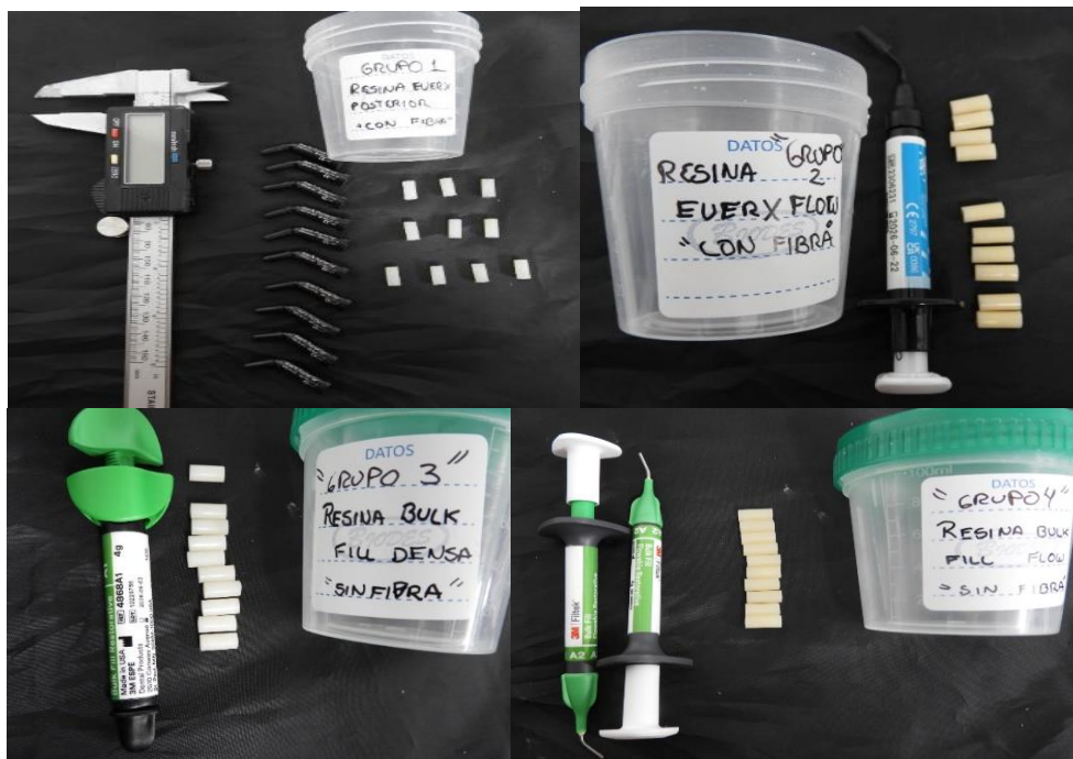
Imagen 7: 40 muestras cilíndricas 4mm x 10 mm.
