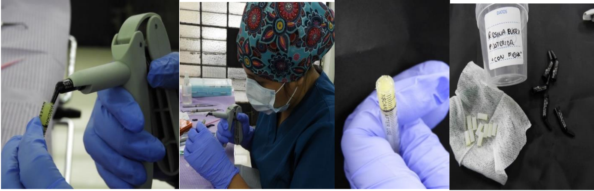
Imagen 3: Confección de 10 muestras de resina de alta densidad con fibra de vidrio (EverX Posterior™ GC).
