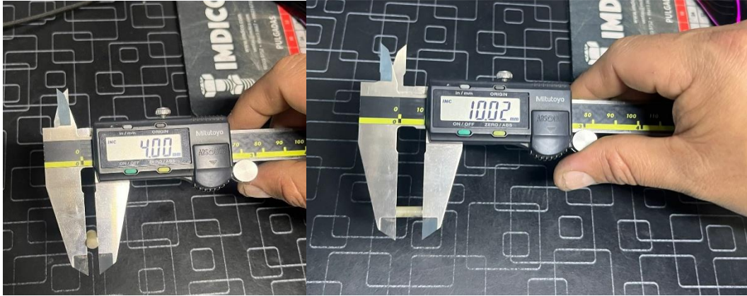
Imagen 9: corroborando las medidas con la ayuda de un pie de rey digital Mitutoyo-200 mm.
