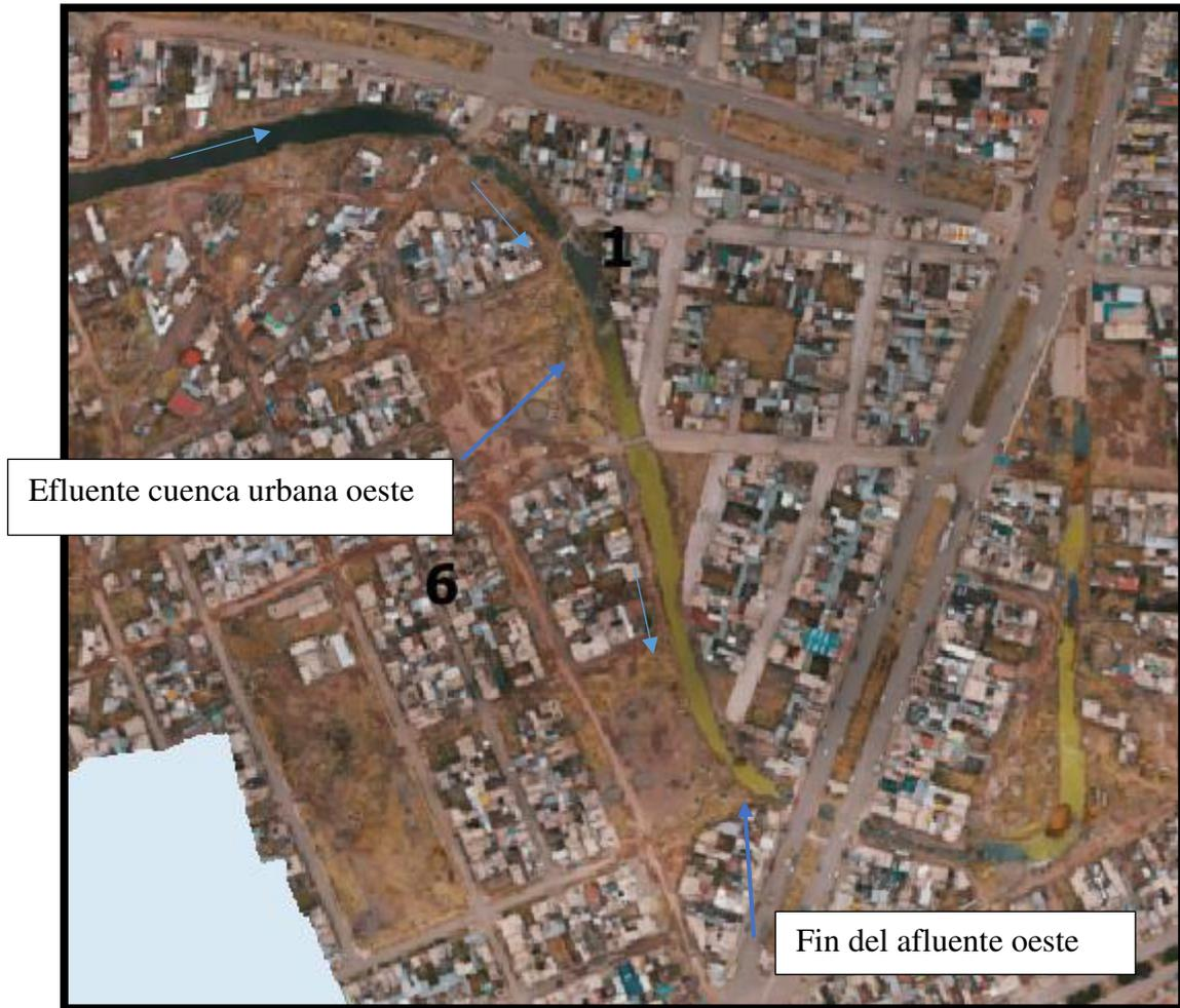
Nota. Se puede notar en la imagen, que el afluente presenta dos colores, un azulino, aguas arriba, para pasar a un color amarillento, hasta el final de afluente. En la imagen, el afluente que se ve de color amarillo, se encuentra actualmente colmatado con tierra y basura.
