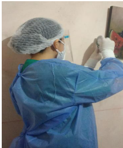
Calibrando el inclinómetro a 0° sobre la pared vertical.
