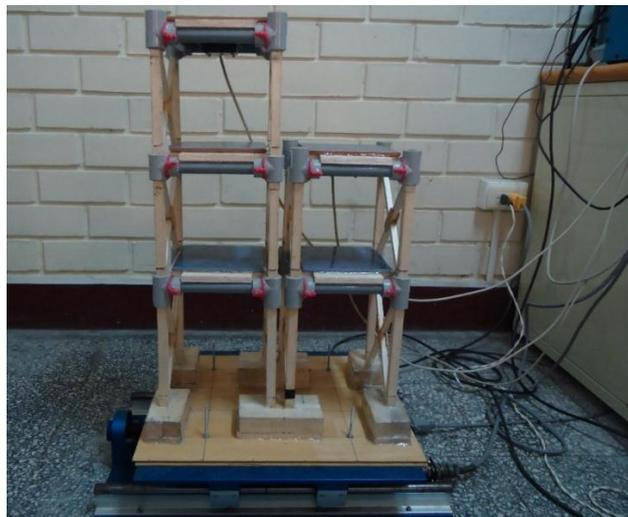
**Figura 45.** Montaje de acelerómetros sobre modelo para medición de señales.
