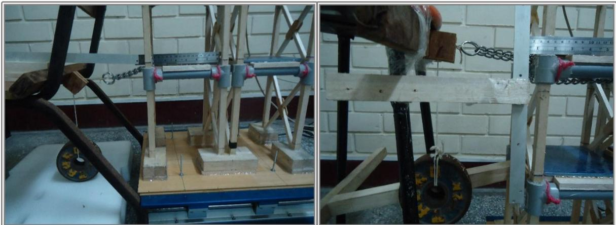
**Figura 50.** Izquierda medición aproximada de rigidez de primer nivel (altura diferente); derecha medición aproximada de rigidez de segundo nivel (altura típica).
