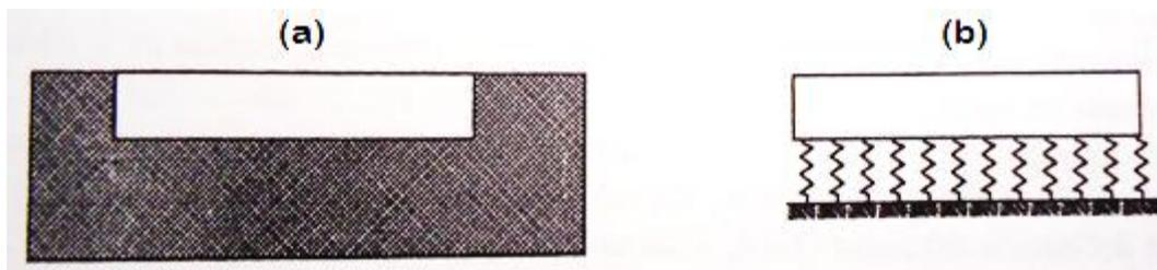
**Figura 8.** Gráfico muestra a) viga desplantada en suelo deformable y b) idealización con apoyos elásticos deformables. (de Tena, 2007)
