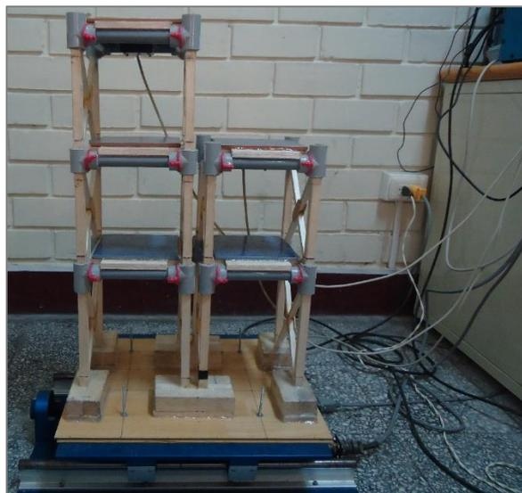
Figura 53. Montaje final para ensayos en condición empotrada.
