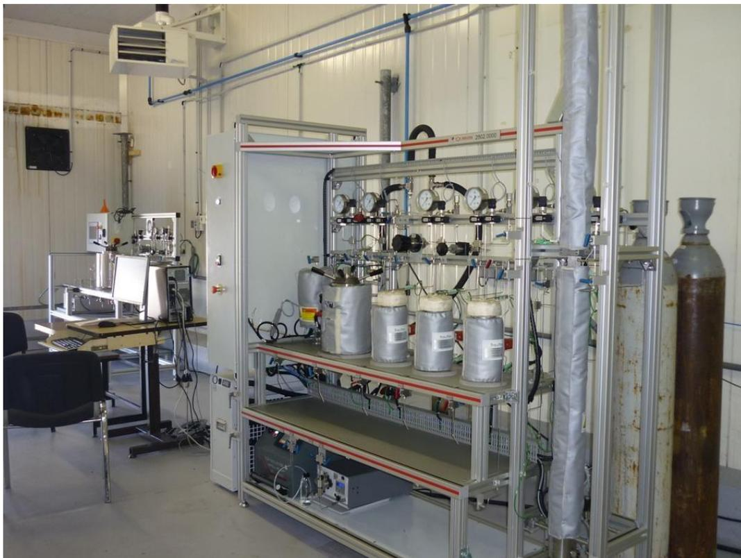
*Figura 9.* Equipo extractor multisolvente de fluidos supercríticos.
