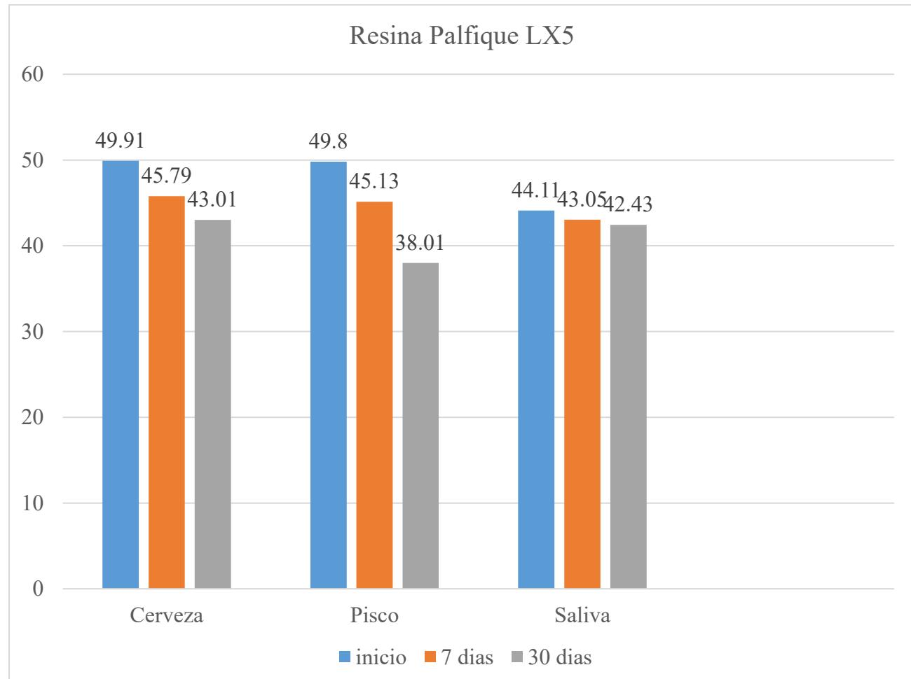
*Nota.* En la figura podemos observar la diferencia que existe en la microdureza superficial entre las medidas inicial, 7 días y 30 días en la resina Palfique LX5, siendo la mayor  $49.91 \pm 2.001$  HV en la bebida cerveza,  $49.80 \pm 3.504$  HV en la bebida pisco y  $44.11 \pm 2.253$  HV en la saliva, todas en la medida inicial.
