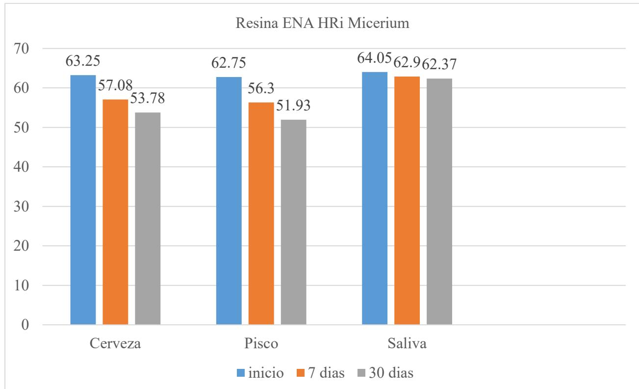
*Nota.* En la figura podemos observar la diferencia que existe en la microdureza superficial entre las medidas inicial, 7 días y 30 días en la resina ENA HRi Micerium, siendo la mayor  $63.25 \pm 3.166$  HV en la bebida cerveza,  $62.75 \pm 4.434$  HV en la bebida pisco y  $64.05 \pm 6.262$  HV en la saliva, todas en la medida inicial.
