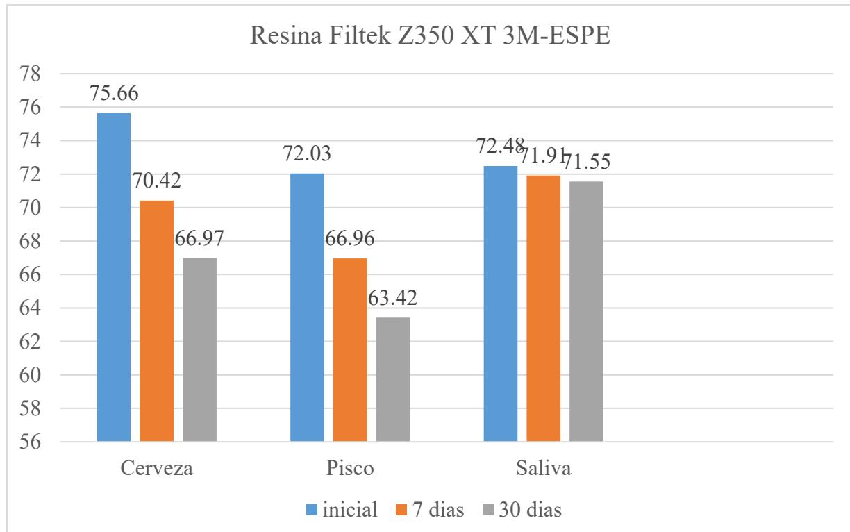
*Nota.* En la figura podemos observar la diferencia que existe en la microdureza superficial entre las medidas inicial, 7 días y 30 días en la resina Filtek z350 xt 3M, siendo la mayor  $75.66 \pm 2.600$  HV en la bebida cerveza,  $72.03 \pm 3.386$  HV en la bebida pisco y  $72.48 \pm 4.135$  HV en la saliva, todas en la medida inicial.
