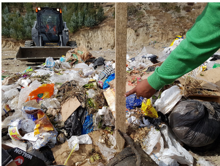
Altura de residuos sin compactar (0.40m)
